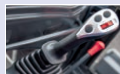
Proportional-Joystick mit Daumenhilfssteuerung
